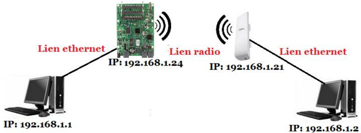
Architecture réseau et adressage équipements
